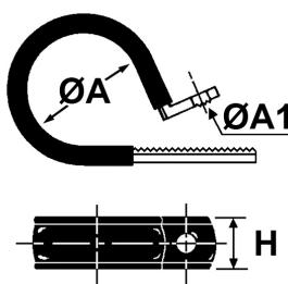
Collarini con rivestimento e protezione in neoprene regolabili
